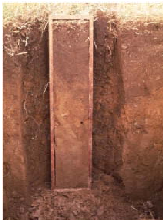
写真-6 土柱に木枠を押しはめる。 Phot. 6. The box is pushed over the soil column.
