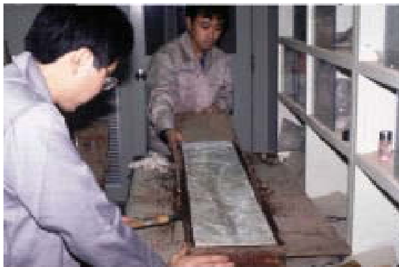
写真-15 長鋸での切り出し。両刃鋸で切り進みながら上部の木の枠の部分を切り取る。 Phot. 15. After handworking, the soil pool is cut off with a double-edged saw.
