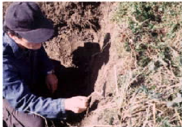
写真-4 試坑を掘り、押取面を平滑にする。 Phot. 4. A pit is dug and one wall is smoothed.
