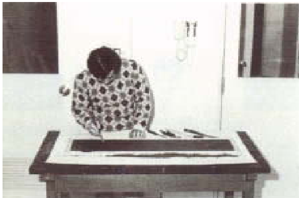
写真-19 ナイフの尖などでほぐして整形する。 Phot. 19. The surface of the soil pool is carefully reaked with a knife to reveal the structure.
