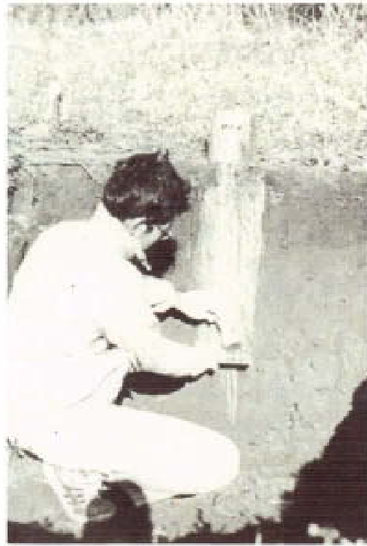
写真-23 板を垂直に当てて、流れ落ちる樹脂を受け止めながら塗る。 Phot. 23. Applying the resin from the top so as to make it flow down.
