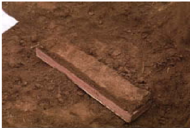
写真-8 断面を平らに倒って蓋をする。 Phot. 8. After levelling the profile, the lid is screwed.
