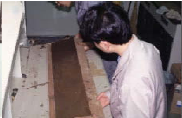
写真-18 マウンティングボードに木工用ボンドを塗り，調整取った断面をマウンとする。 Phot. 18. The soil pool is marked on the mounting board, on which enough adhesive is placed before hand.
