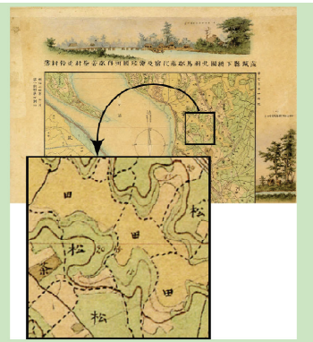
茨城県牛久市牛久沼周辺の「迅速測図」。名称は、迅速に測量を行うという意味の「迅速測図法」に由来します(国土地理院所蔵、第一軍管地方二万一分迅速測図原図より作成)。
