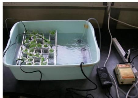
写真7 サーモを使って温度保持をする
