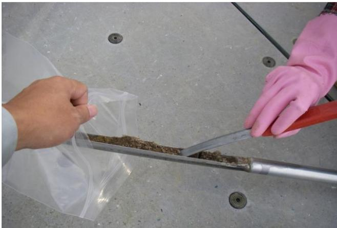
写真4 専用のヘラを用いて土壌をサンプルング袋へ入れる。
